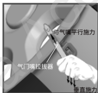
3. 使用气门嘴拉拔器 安装传感器总成
